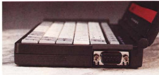
Le interfacce sono poste lateralmente: da sinistra, la porta parallela, la porta per il drive e sul lato opposto la porta seriale.
