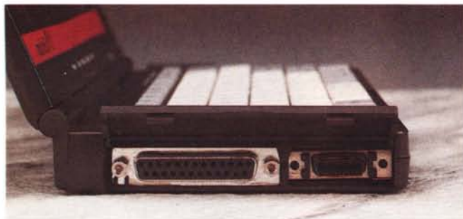
Le interfacce sono poste lateralmente: da sinistra, la porta parallela, la porta per il drive e sul lato opposto la porta seriale.
