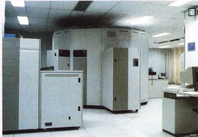
Il robot Storagetek, che tratta automaticamente le cassette di nastro magnetico.
