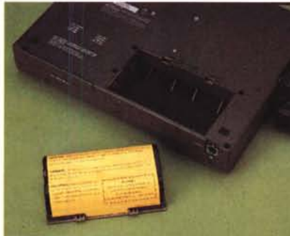
L'accumulatore ed il vano che lo ospita nel fondo del notebook.
