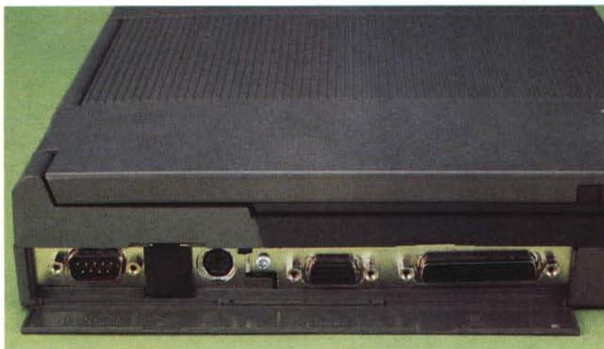
terfacce standard col mondo esterno già disponibili «on board». Non manca quindi una porta parallela, una porta seriale, una seconda seriale con connettore minidin (PS/2 like) per il mouse, l'uscita video VGA e un tappeto di plastica sotto al quale troveremo l'uscita telefonica una volta installato il modem interno.
