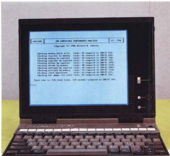
La qualità del display LCD è elevata anche grazie alla buona capacità di visualizzare i colori come toni di grigio.
