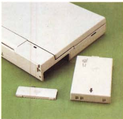
L'accumulatore estraibile è protetto da uno sportellino rimovibile.
