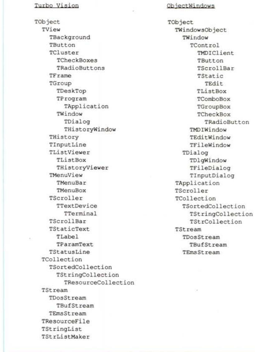
Figura 2 - Le gerarchie di classi di Turbo Vision e ObjectWindows.
