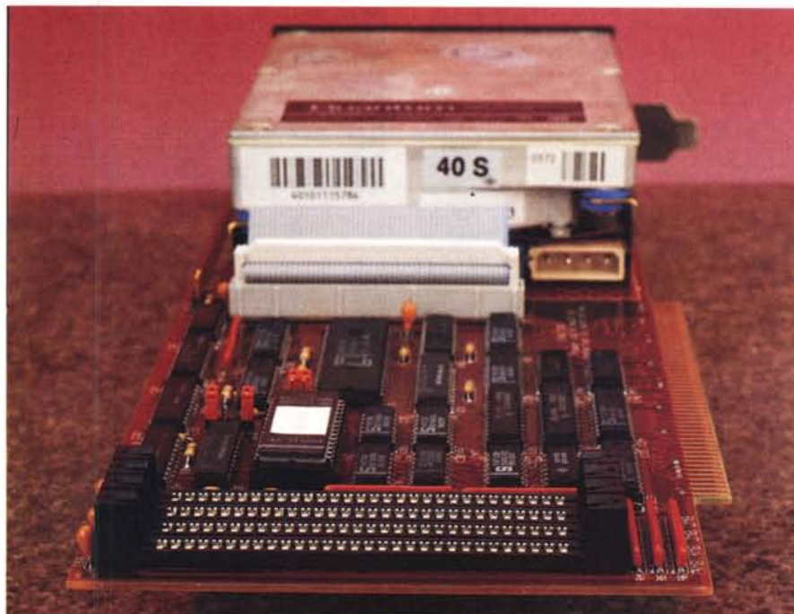
La scheda subito dopo aver montato la meccanica, un ProDrive da 40 Mbyte della Quantum. Da notare i quattro connettori SIMM, pronti a contenere fino ad 8 Mbyte di RAM.
