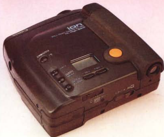
La maggior parte dei comandi è posta sul lato superiore. A sinistra, il collegamento macchina-scheda è assicurato da un cavo fornito nel kit.
