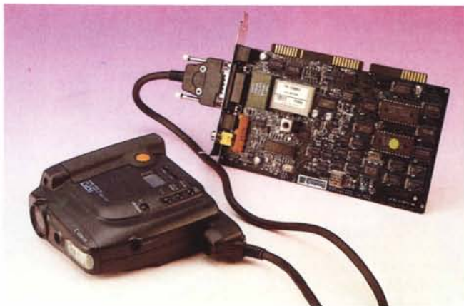
La maggior parte dei comandi è posta sul lato superiore. A sinistra, il collegamento macchina-scheda è assicurato da un cavo fornito nel kit.
