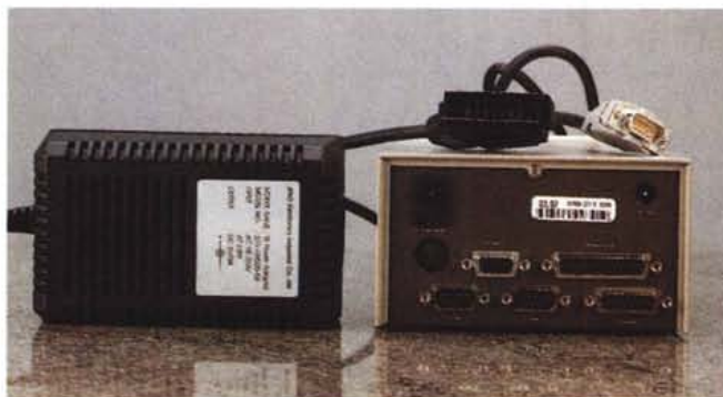
Parte posteriore del Tiny 650 e relativo alimentatore switching
