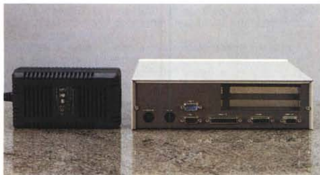
Parte posteriore del Tiny 650 Pro e relativo alimentatore switching
