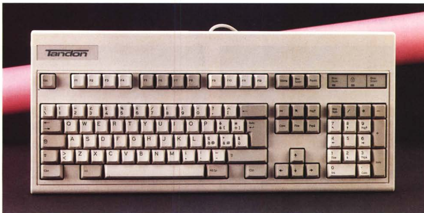
La bella tastiera in dotazione che consente l'inversione dei tasti CTRL e CAPS LOCK sul lato sinistro.
