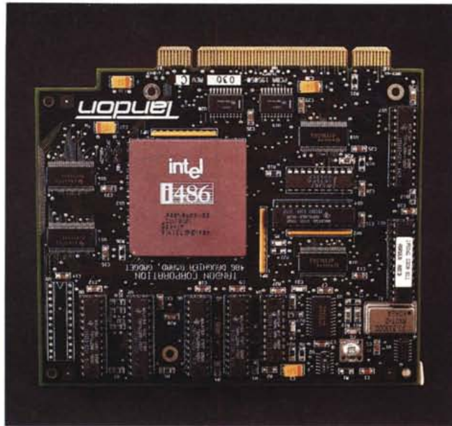
La scheda del microprocessore che può facilmente essere sostituita per permettere l'up-grade delle caratteristiche del sistema. In questo caso è ben visibile il 486 a 33 MHz di clock.
