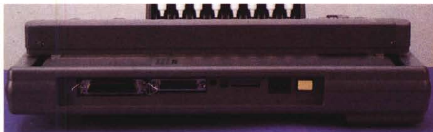
Sul lato destro del plotter sono presenti i connettori di interfacciamento, i dip-switch di settaggio dei parametri e l'interruttore di accensione.
