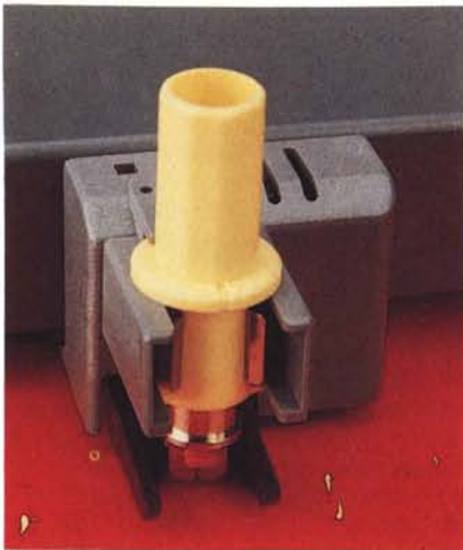
Il kit di taglio si compone di questo supporto girevole per le lame e di un certo numero di lamette facilmente sostituibili dall'utente. A fianco è possibile vedere l'interno del plotter, molto ordinato e pulito.
