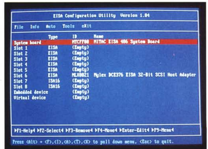
Attraverso l'EISA configuration utility è possibile configurare le schede inserite nel bus EISA.
