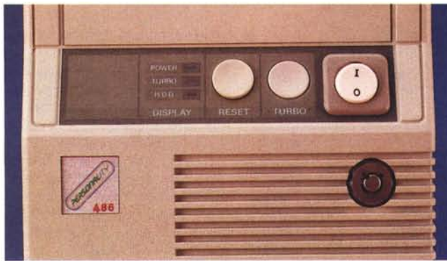
◀ Sul frontalino sono posti i led, il pulsante di reset e l'interruttore di accensione.
