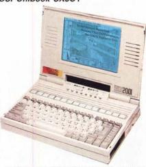
La Universal Scientific Industrial propone questo notebook basato su processore 386SX con frequenza di clock a 16/20 MHz, 2 Mbyte di RAM standard espandibile fino a 10 Mbyte mediante SIMM. Un hard disk da 20 Mbyte ed un display LCD a standard VGA capace di visualizzare 16 livelli di grigio completano la configurazione di questo notebook capace di offrire un'autonomia compresa tra 2 e 4 ore.
