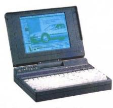
Sampo è un marchio particolarmente conosciuto a Taiwan; il portatile proposto è realizzato utilizzando il processore 386SX a 20 MHz e presenta le caratteristiche generali di questo tipo di prodotti con in più una serie di soluzioni rivolte al risparmio di energia: frequenza di clock del processore ridotta a 4 MHz in caso di inattività; funzioni di stand-by per CPU e bus I/O; funzioni di sleep per hard disk e display.
