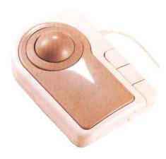
zione che può variare da 50 a 1200 dpi con una velocità massima di tracciamento di 900mm al secondo. L'interfaccia è di tipo seriale e la vita media garantita è di 1.000.000 di operazioni per ogni tasto e circa 100 miglia per l'uso della sfera.
