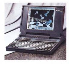
In un peso di 2.6 kg, questo notebook offre la potenza di calcolo del processore 386SX a 20 MHz, una RAM da 4 a 8 MByte, hard disk da 20 o 40 Mbyte, un display LCD a standard VGA ed un'autonomia delle batterie di circa 2 ore.
