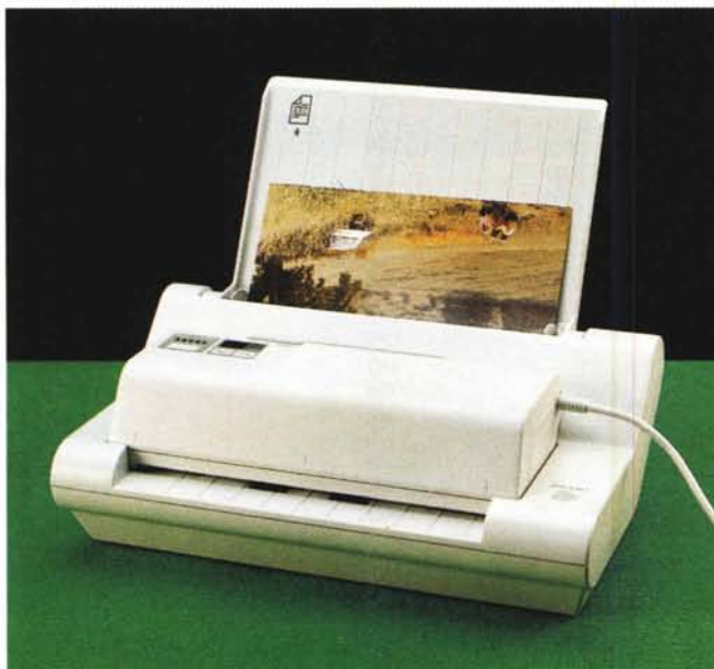
Lo scanner nelle due modalità operative: completo di sheet feeder e usato manualmente.
