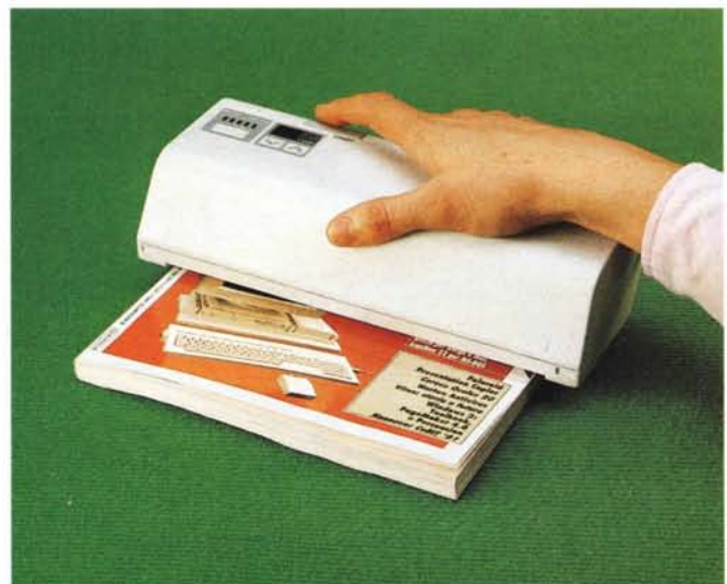
Lo scanner nelle due modalità operative: completo di sheet feeder e usato manualmente.
