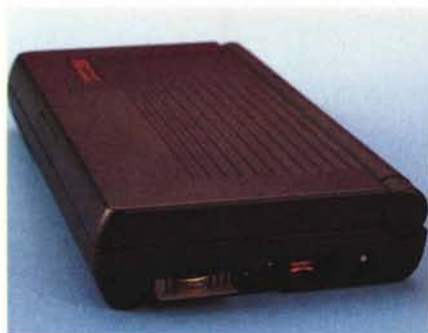
Il lato destro ospita l'interfaccia seriale, il connettore di alimentazione esterna ed il link ottico (raggi infrarossi).
