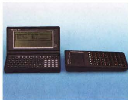
L'HP 95LX è in grado di scambiare file con altre calcolatrici, come ad esempio l'HP48.
