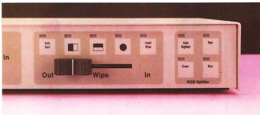
L'inusuale sezione Wipe ci consente di abbellire con tendine e cerchi i nostri lavori, ma quello che ci offre l'RGB Splitter è certamente di più e meglio; un vero auto-controllo di un dispositivo come il DigiView ad un costo praticamente zero. Veramente notevole.
