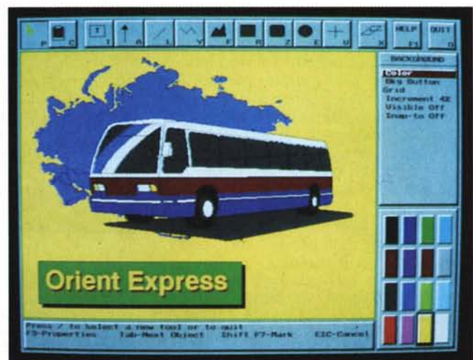
Figura 8 - Borland Quattro Pro 3.0 - L'ambiente Annotate. L'Annotate è un vero e proprio programma grafico di tipo Drawing, tramite il quale si può maneggiare il diagramma prodotto con le funzioni di Business Graphics, ma non solo. Ora dispone di utility di griglia e snap e di funzioni di allineamento degli oggetti e inoltre proprio per l'Annotate, il prodotto accessorio ProView mette a disposizione un centinaio di figure Clip Art.
