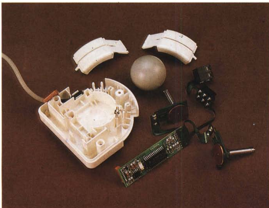
▼ Vista dell'interno. Si noti la componentistica ridottissima e altamente integrata ed il chip ASIC Motorola.
