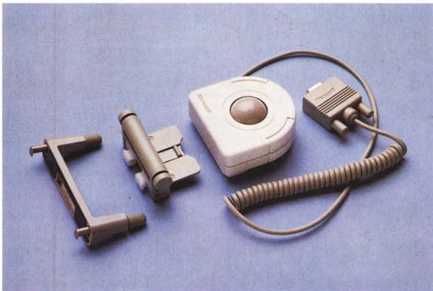
Esplso del dispositivo in cui si notano i due pezzi del morsetto ed il corpo del trackball.
