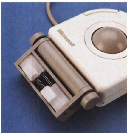
Particolare della possibilità di fissaggio riservata ai computer con una tastiera «predisposta».
