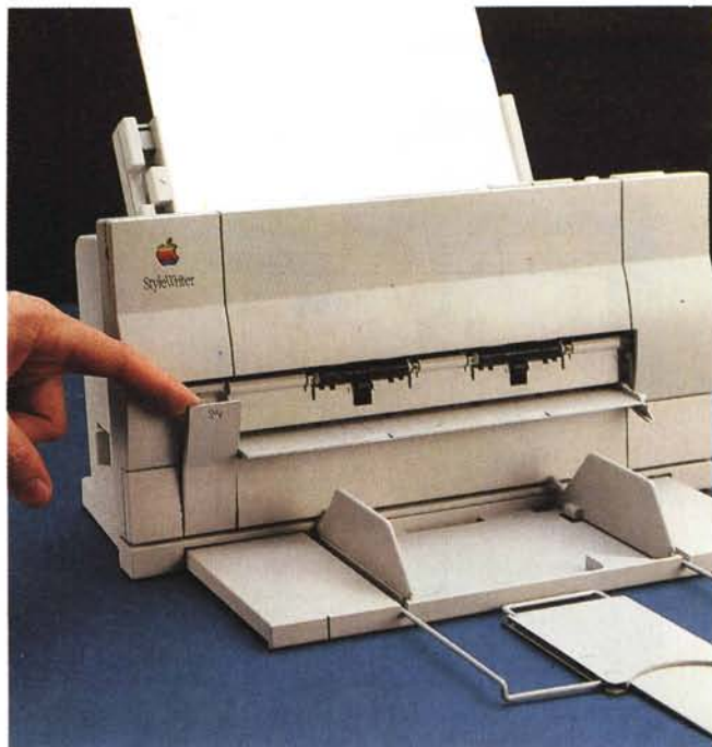
Per accedere alla cartuccia di inchiostro è sufficiente ribaltare il pannello frontale; nell'angolo in alto a sinistra la leva per l'uso delle buste. È possibile introdurre manualmente i fogli ed estrarre fogli inceppati nei meccanismi.
