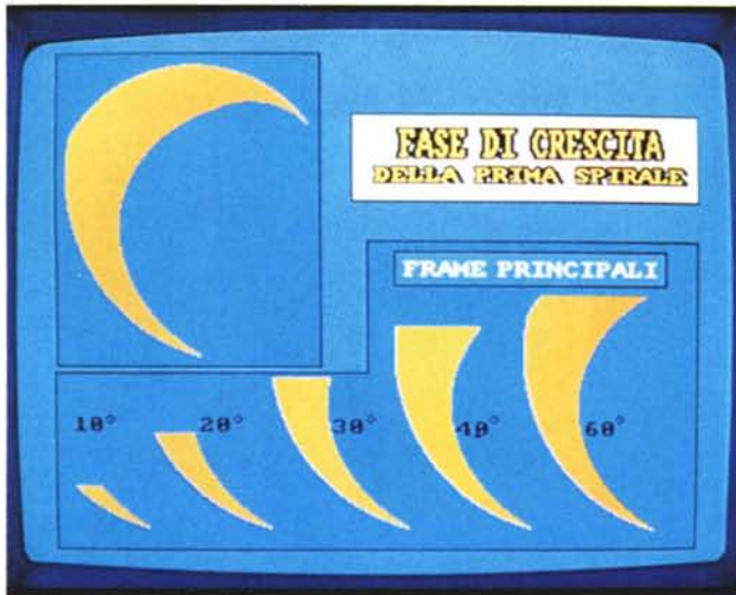
Figura 8 - La crescita animata di ogni spirale avverrà con un effetto simile al riempimento di un bicchiere. In questa diapositiva vengono rappresentati alcuni fotogrammi principali dell'ANIMbrush che contiene l'intero set di frame. Maggiore sarà il numero di questi frame e il loro SetRate, maggiore sarà l'effetto di fluidità.
