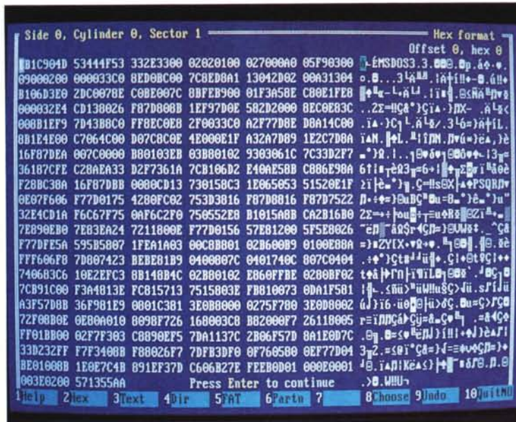
Lo stesso boot sector modificato a seguito dell'infezione da «Ping Pong».
