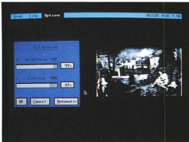
Figura 1 - Coreco Oculus 20 — Controllo del contrasto e della luminosità. La Scheda Digitalizzatrice tramite collegamento a telecamera Oculus 20, prodotta dalla casa canadese Coreco, viene fornita, su richiesta, di un software molto recente e particolarmente semplificato, che si occupa solo del settaggio dei parametri, del controllo della ripresa e del salvataggio del file intero, e quindi del formato del video, o di una sua finestra.
