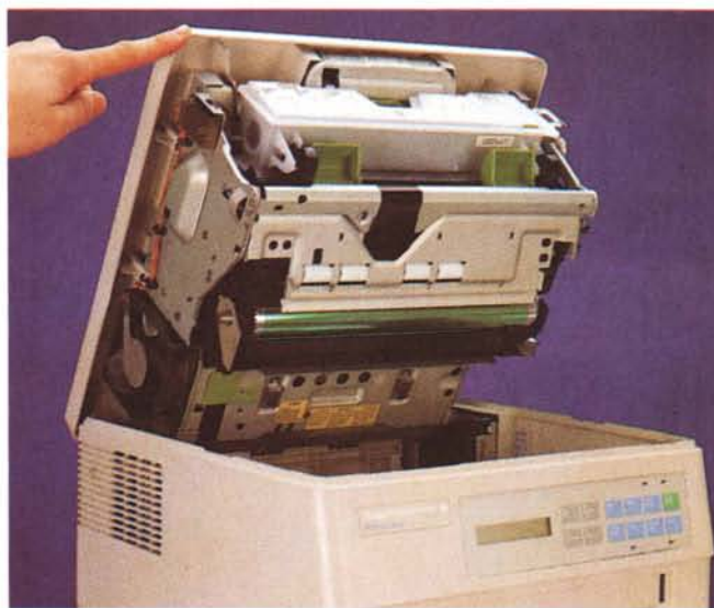
Il retro della microLaser con lo sportello di uscita carta aperto per la raccolta in ordine decrescente e la sezione della meccanica che ospita la cartuccia di toner.
