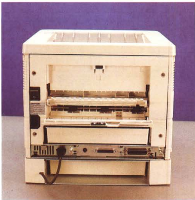
Il retro della microLaser con lo sportello di uscita carta aperto per la raccolta in ordine decrescente e la sezione della meccanica che ospita la cartuccia di toner.
