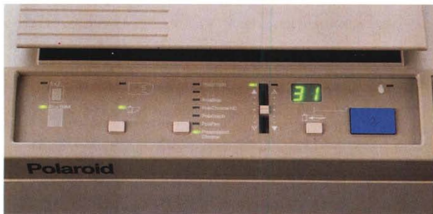
Il pannello di controllo, la zona che ospita i due dorsi fotografici (35 mm e Polaroid) ed il piano di scansione adatto anche a piccoli oggetti di spessore non molto elevato.
