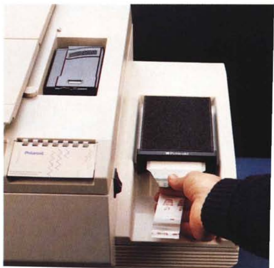
Il pannello di controllo, la zona che ospita i due dorsi fotografici (35 mm e Polaroid) ed il piano di scansione adatto anche a piccoli oggetti di spessore non molto elevato.
