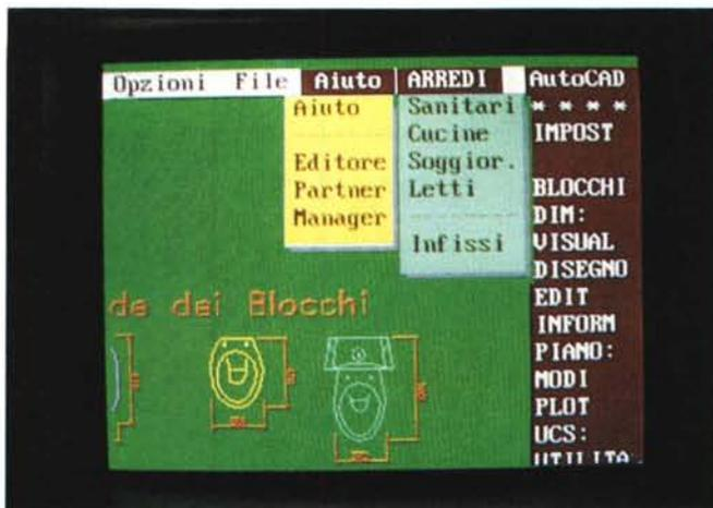
Figura 10 - AutoCad 386 Particolare dei menu. Qui vediamo un collage di menu che mostra insieme (nella realtà ne appare uno alla volta) i menu costruiti nell'esercizio. Ricordiamo che la barra dei menu può contenere al massimo 10 opzioni. Una opzione può richiamare un altro menu a tendina oppure un menu a icone, oppure può eseguire un comando «nativo», una macro, un comando Lisp, ecc.
