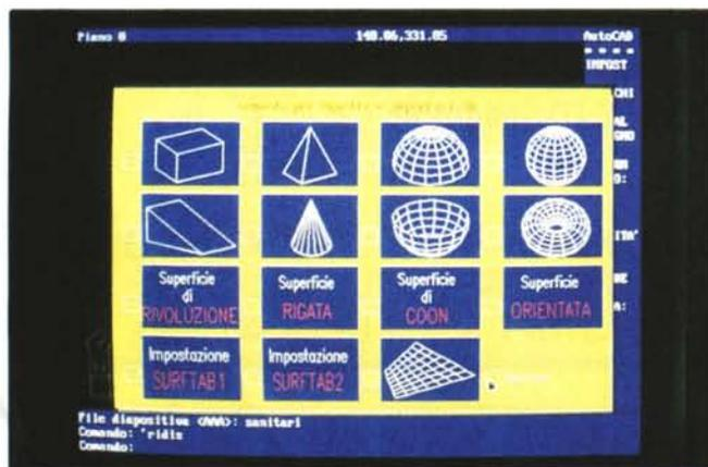
Figura 1 - AutoCad 386. Un menu a Icone in dotazione. In questo numero parliamo della costruzione dei menu a Icone con AutoCad. È evidente che la finestra e le «iconcine» in essa contenute sono solo l'aspetto esteriore di una sottostante struttura che coinvolge file di tipo .MNU e file di tipo LSP, opportunamente collegati tra di loro.
