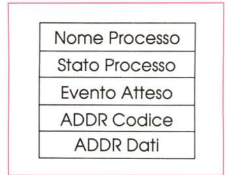
Figura 6 - Nel descrittore del processo (PCB, Process Control Block) vengono memorizzate alcune informazioni riguardanti il processo descritto.
