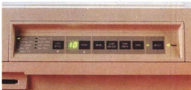
Il pannello che permette numerose operazioni di controllo delle funzionalità delle stampanti P60 e P70. A destra è visibile il sensore di prossimità che assicura l'annullamento delle procedure all'apertura del coperchio.
