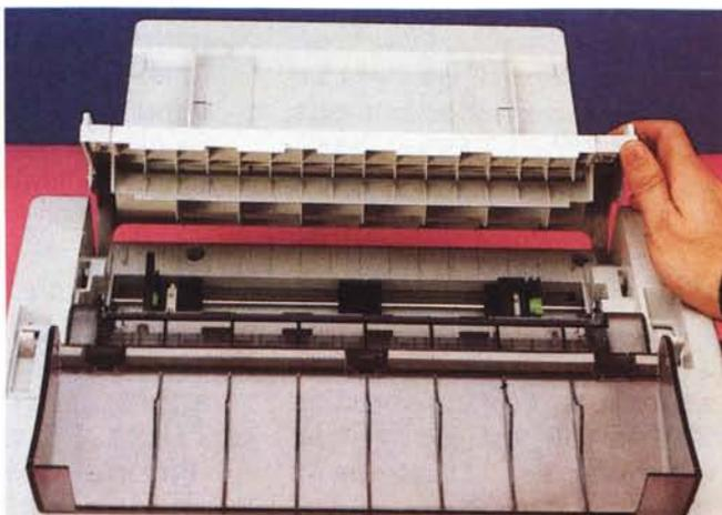
Rimosso il coperchio superiore si accede alla testa di stampa ed alla cartuccia di nastro, mentre un secondo coperchio (a destra) permette l'introduzione del modulo continuo.
