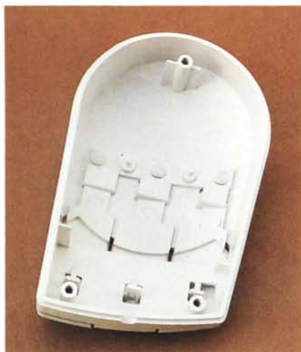
Due particolari dell'interno del Mouse: il guscio ed i relativi tasti che devono sopportare 5 milioni di «click» ed i sensori ottici di movimento.
