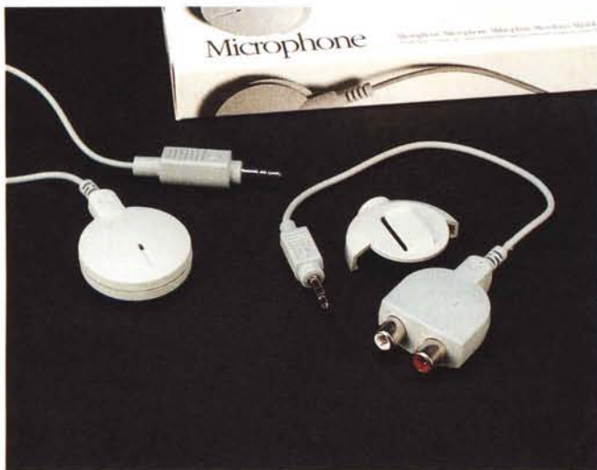
Il microfono di serie, con i relativi cavi, un adattatore per il collegamento all'impianto hi-fi, una clip per l'uso sui vestiti. Nell'hard copy dello schermo è visibile la finestra di gestione dell'input da microfono richiamabile dal pannello di controllo.
