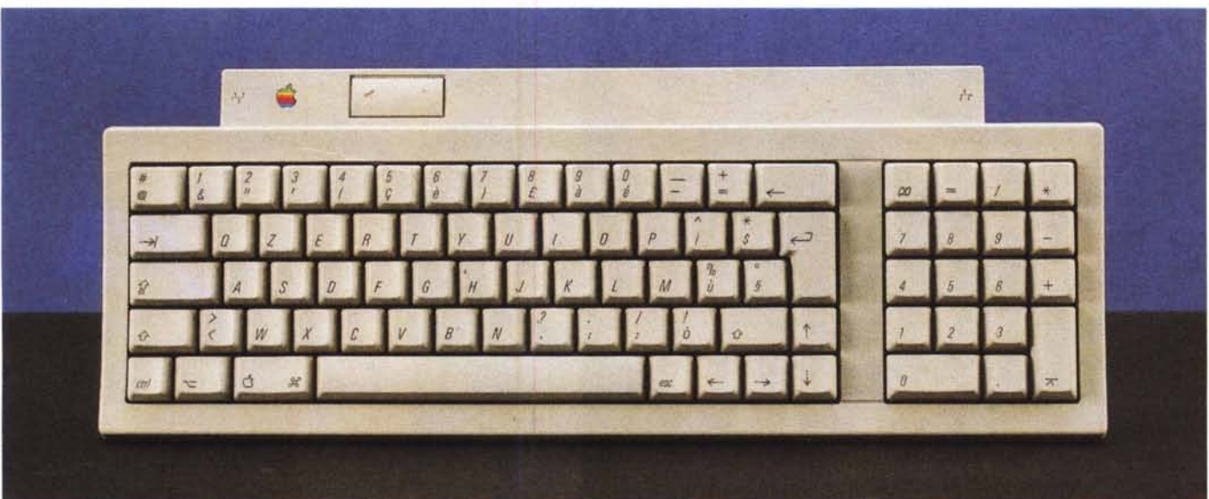
La tastiera fornita in dotazione ricorda quella dell'Apple IIGS, si noti il tasto di reset che in combinazione con altri tasti può sostituire i «tasti programmatore».
