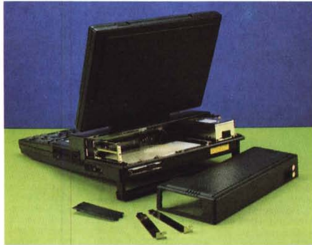
Il nuovo LS 320 è dotato di due slot standard per l'espansione e l'eventuale inserimento in una rete locale senza per questo rinunciare alle doti di trasportabilità del sistema.
