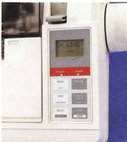
Il pannello operativo e l'alloggiamento per l'inserimento dell'interfaccia seriale RS232C opzionale e delle IC fond card.
