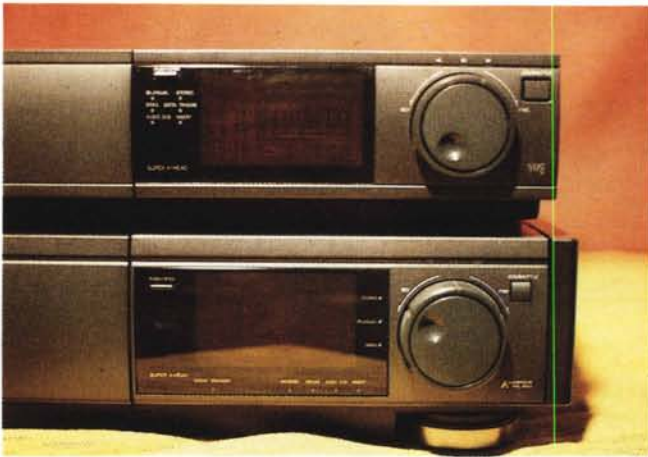
Figura 9 - Primopiano sulle manopole di JogShuttle dell'F70 e dell'FS100. Quindi il telecomando dell'FS100; in pratica un ottimo sostituto della centralina di editing che prima o poi dovrete comperare; tale aggeggio è in grado di comandare lo start sincronizzato di due VCR indifferentemente scelti fra la grande famiglia della serie «F» della Panasonic.
