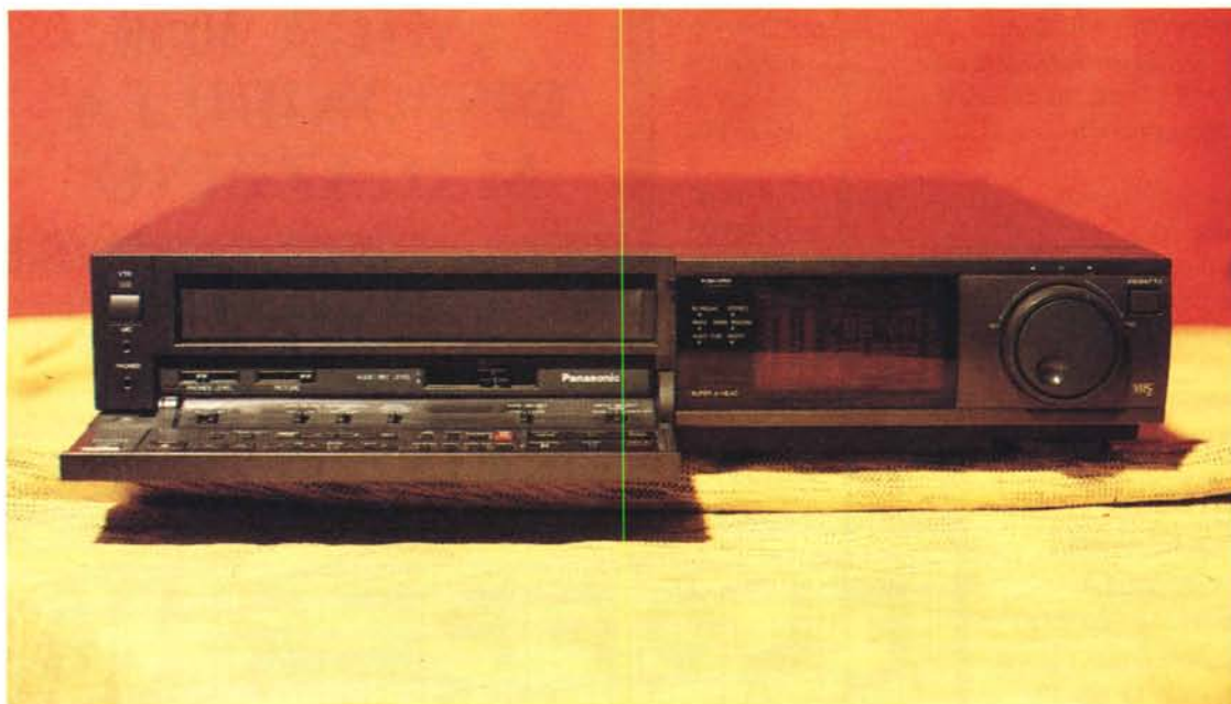
Figura 1 - Pur restando nel «limbo» del VHS, le 250 linee di risoluzione orizzontale e i 43 dB di S/N, l'ottimo gruppo di testine, i circuiti HQ e soprattutto la manopola di Jog-Shuttle per eseguire l'editing in fase di montaggio, fanno del Panasonic NV-F70, il top della videoregistrazione domestica.
