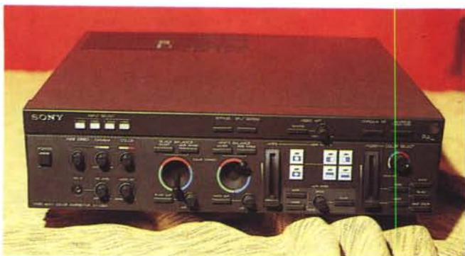
Figura 3 - Uno fra i più raffinati «componenti speciali» già reperibili anche in Italia è questo correttore di colore della Sony. L'XV-C900, svolgendo un'intera sezione di Wipe (di foggia, colori e velocità variabili), Fade IN/OUT video ed audio, manuali ed automatizzabili, è tra l'altro in grado di eseguire codifiche e transcodifiche fra segnali composti e separati (L. 1.300.000).
