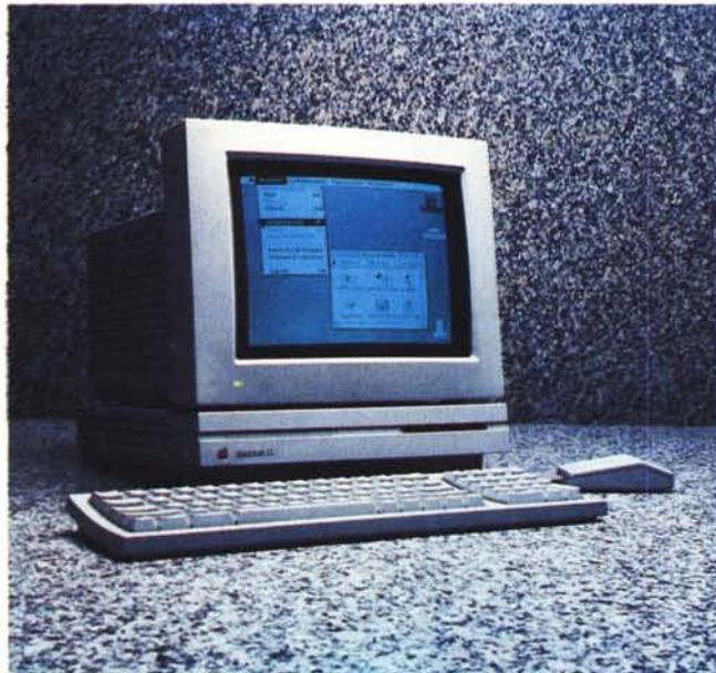
2 Mbyte e può essere espansa fino a 17 Mbyte; la scheda video a 8 bit incorporata permette il collegamento ai monitor già citati per il Macintosh LC con l'aggiunta del monitor verticale monocromatico da 15" (con visualizzazione di fino a 16 toni di grigio), senza aggiunta di altre schede video dedicate.
