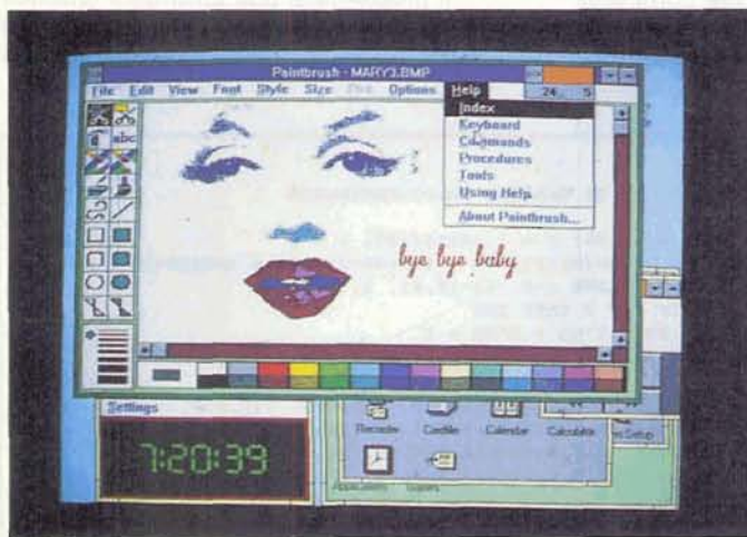
Figura 5 - Modalità video VGA 256 colori. Questa modalità video, permessa dalla «scheda» VGA, consente una riproduzione molto fedele della realtà e quindi ben si presta alla riproduzione di immagini di tipo fotografico in cui serve una buona fedeltà ad un originale. I pixel sono solo 320 per 200, ma i colori, 256 scelti tra 262 144, e compensano abbondantemente la riduzione della risoluzione.
