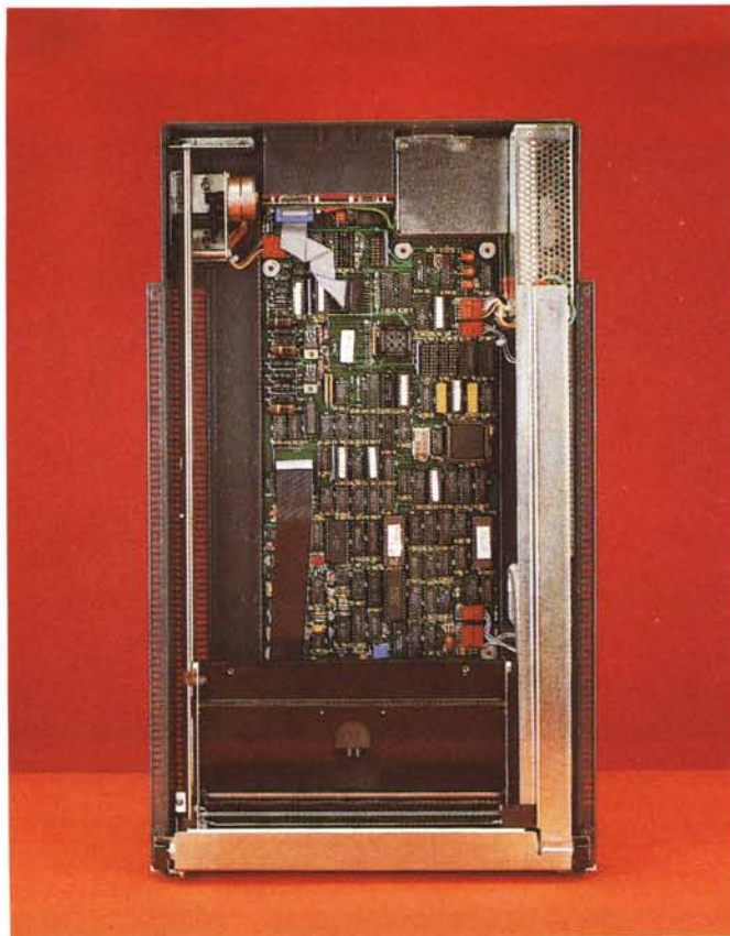
L'interno dell'AVR 3000/GS è occupato da una scheda che ne gestisce il funzionamento e, in alto, dalla sezione di alimentazione e dal gruppo elettromeccanico che consente gli spostamenti del sensore CCD e della relativa lampada per l'acquisizione dei documenti.
