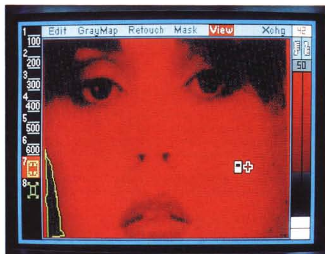
Con le barre visualizzate sulla destra dello schermo è possibile conoscere il valore in percentuale di ogni tonalità di grigio ed operare una «protezione» su una gamma di essi.
