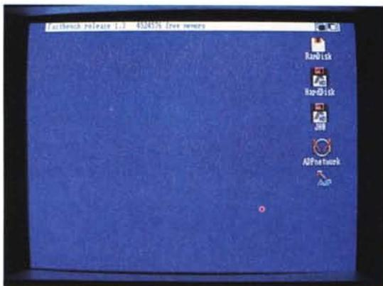
Una volta installata la rete, appare sul WorkBench una nuova icona a forma di anello, come la struttura di ADPNetwork.
