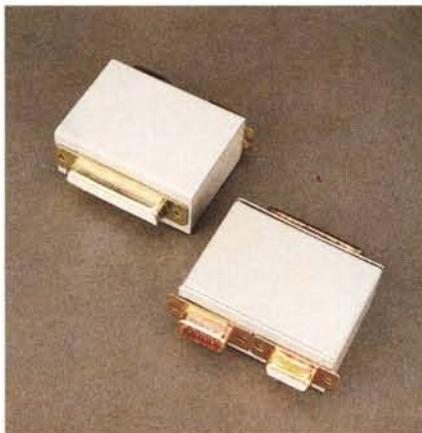
*Per collegare due sole macchine in rete attraverso l'interfaccia seriale è sufficiente un comunissimo cavo Null Modem tra le due macchine. Per collegare, di contro, più di due macchine è necessario dotare ogni nodo di uno «sdoppiatore passivo» di seriale: nella foto è mostrato il prototipo da noi utilizzato, mostrato frontalmente e posteriormente.*
