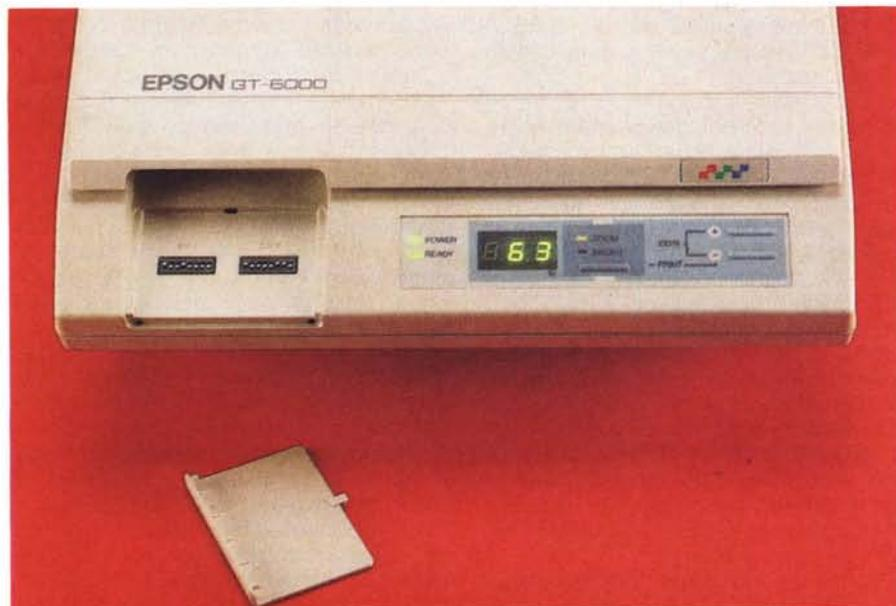
Il pannello operativo e, celati da uno sportellino rimovibile, due banchi di dip-switch per la configurazione. Il coperchio superiore è facilmente asportabile.
