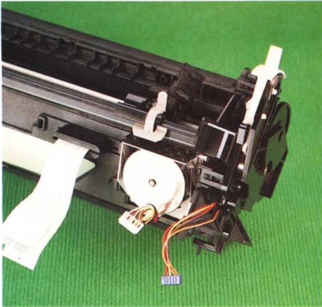
Nel particolare del monoblocco della meccanica sono visibili i connettori di collegamento dei motori all'elettronica di controllo ed i due flat-cable di collegamento della testa di stampa.
