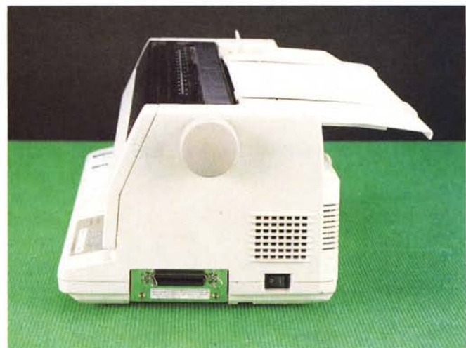
Il pannello di controllo è posizionato in una zona molto comoda per l'operatore. Nella veduta laterale è ben visibile lo sviluppo verticale della stampante.
