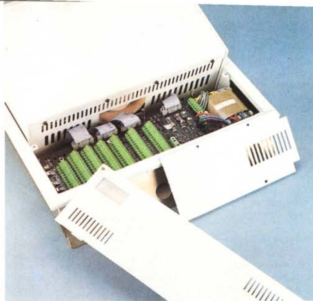
Tolte le due mascherine di protezione si accede alla morsettiera elettrica di plastica dura a cui vanno collegati elettricamente i vari sensori o pulsanti, le utenze ed il cavo TV per la telecamera. Da notare una piccola lente di Fresnel che permette alla sottostante cellula a raggi infrarossi di rilevare la presenza di persone.
