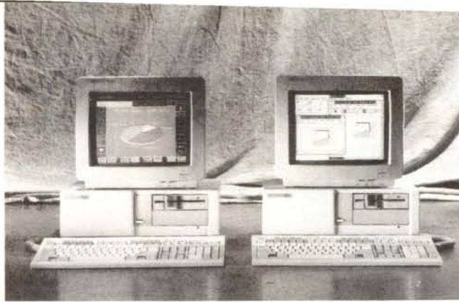
tempi medi di accesso di 17 ms e velocità di trasferimento dei dati fino a 10 Mbit/sec completano la dotazione comprendente anche porta seriale e parallela, sette slot di espansione del bus ISA, supporto dei coprocessori matematici Intel 80387 e Weitek WTL-3167 a 25 MHz.
