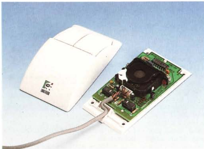
Il mouse aperto: sulla piccola scheda sono ben visibili i due micro-switch corrispondenti ai tasti; il coperchio è stato invece posizionato al contrario per mostrare il simpatico logo della Logitech.
