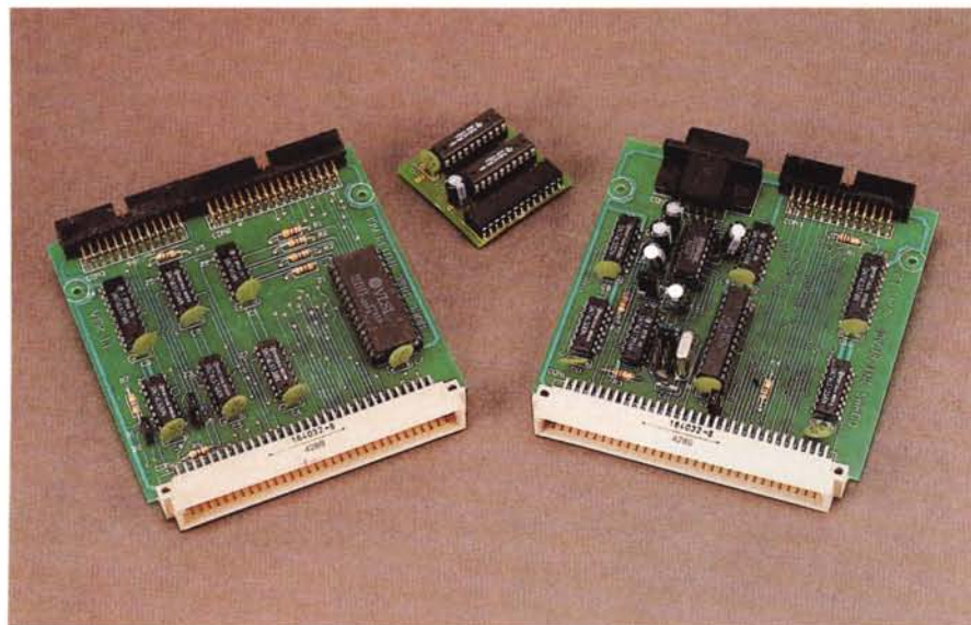
L'interno delle due interfacce, rispettivamente SDI (floppy/parallela) e seriale/parallela, e l'espansione di memoria di 256 Kbyte.
