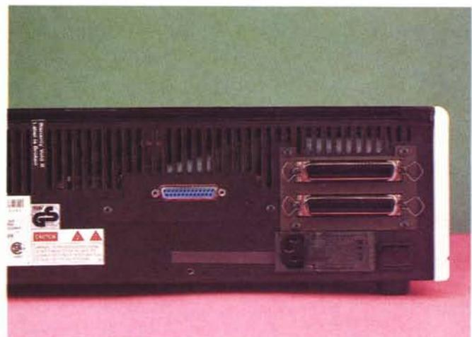
Il pannello operativo a disposizione dell'utente e, qui sopra, la ricca dotazione di connettori per l'interfaccia parallela e SCSI.
