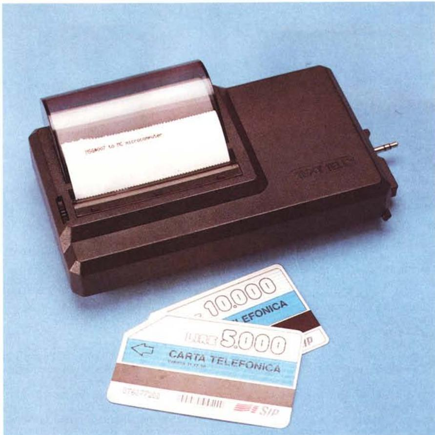
La PXP40 stampa in 80 colonne su carta termica. Il rotolo è protetto da un coperchio di plastica e lateralmente sporge il jack per la connessione al PX1000F.
