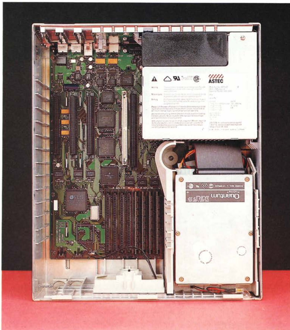
L'interno della macchina; visibile la sezione alimentatrice, i due drive al di sopra della motherboard; il coprocessore matematico, gli slot per le RAM e le parti libere per le schede accessorie.
