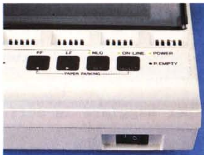
Il pannello di controllo ed i connettori di interfaccia ubicati sul fondo della stampante.
