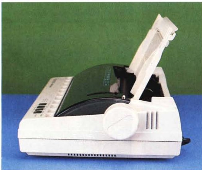
Il coperchio guida carta nelle due posizioni operative possibili: una per il modulo continuo, l'altra per i fogli singoli.
