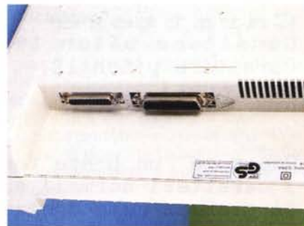
Il pannello di controllo ed i connettori di interfaccia ubicati sul fondo della stampante.
