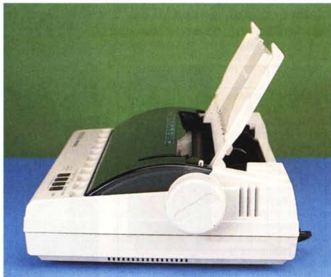
Il coperchio guida carta nelle due posizioni operative possibili: una per il modulo continuo, l'altra per i fogli singoli.
