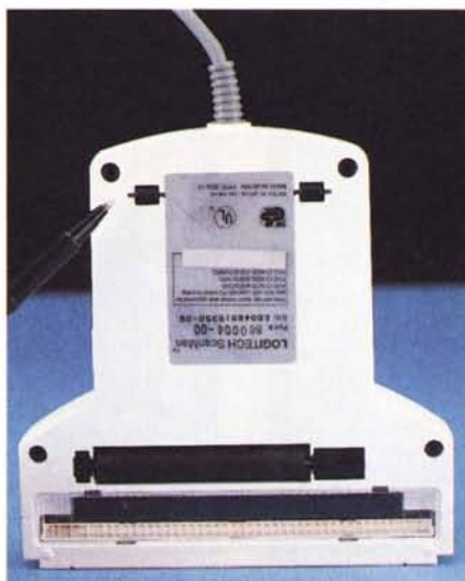
Particolare dei rullini posteriori, che assicurano una scansione lineare, del disegno da digitalizzare.
