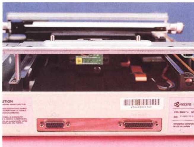
Il retro del Kyocera mostra il connettore di interfacciamento ed il connettore per l'inseritore automatico degli originali; al centro è visibile la piccola piastrina corrispondente al sensore CCD. Lo scanner aperto mostra le generose dimensioni del tubo al neon per l'illuminazione del documento.
