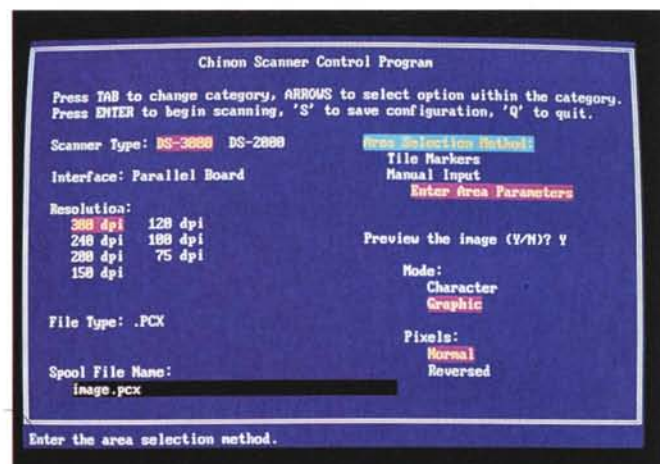
Due immagini del software di gestione Chinon: a sinistra, la modalità preview permette di definire la finestra di scansione; a destra, la serie di menu che permette di impostare i parametri di funzionamento ed acquisizione.
