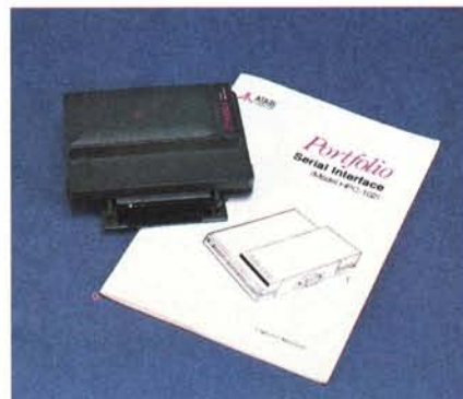
L'interfaccia seriale permette trasmissioni a velocità comprese tra 110 e 9600 baud.
