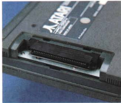
Al bus di sistema possiamo collegare interfacce, espansioni di memoria da 256 K e un lettore aggiuntivo di memory card.
