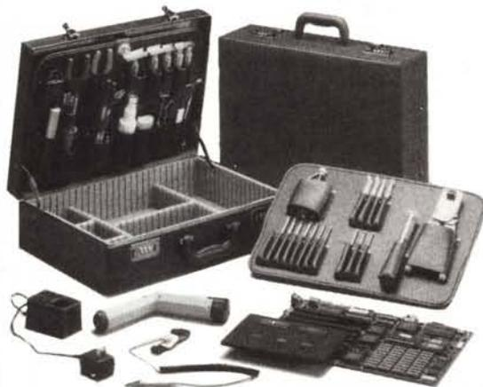
Estrattori di Ram - Eprom - Giraviti a batteria
